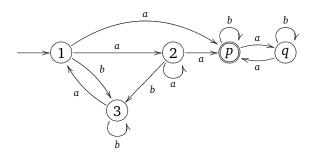
Falls Zustand 1 in  $\mathcal{A}_1$  auch akzeptierend ist, muss in diesem Automaten der Zustand 1 auch akzeptierend sein und es muss eine a-Transition von 1 nach q sowie eine b-Transition von 1 nach p und eine a-Transition von 3 nach p hinzugefügt werden (warum?).
