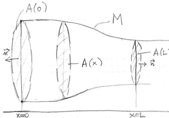
Abbildung 1: Eindimensionale Rohrströmung
