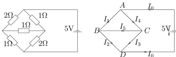
Berechnen Sie die Stromstärken  $I_0, \dots, I_5$  und den Gesamtwiderstand der Brücke!
