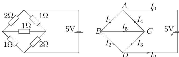
Berechnen Sie die Stromstärken  $I_0, \dots, I_5$  und den Gesamtwiderstand der Brücke! Verwenden Sie beim Lösen des linearen Gleichungssystems mit Gauß die Matrizenform aus (G 11), um Zeilenumformungen auszudrücken!
