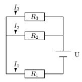
Der Zusammenhang zwischen der Spannung U, den Widerständen  $R_1, R_2, R_3$  und den resultierenden Stromstärken  $I_1, I_2, I_3$  ist durch die **Kirchhoffschen Gesetze** gegeben, die hier folgende Gleichungen erzwingen:
